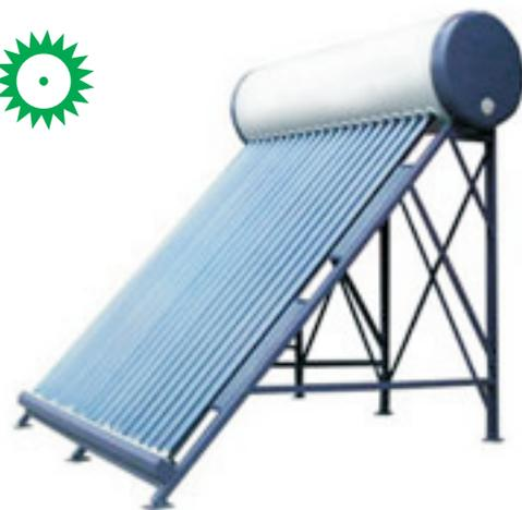
Les panneaux fonctionnent selon un principe très simple: ils captent l'énergie qui provient du Soleil sur le tube de verre sous vide et utilisé pour produire l'eau chaude. La température de fonctionnement peut dépasser 90°. L'échange de chaleur avec de l'eau dans le réservoir fonctionne par circulation naturelle.
